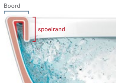
Conventionele wc's met spoelrand | met boord
